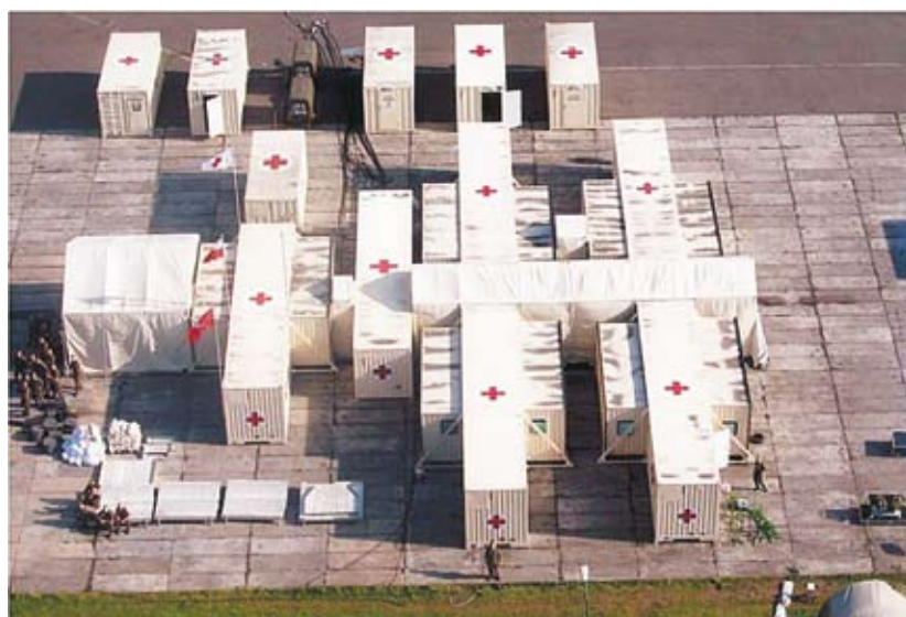
Rzut modułów kontenerowych Szpitala Operacji Pokojowych, z części których zorganizowano szpital polowy w Ghazni
